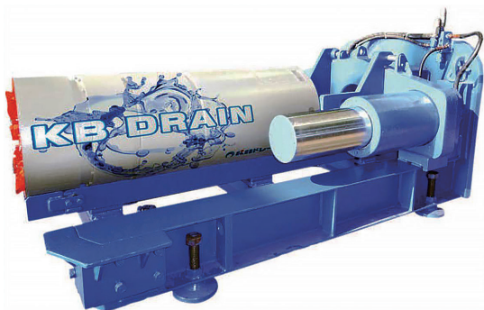
写真－2 KBドレン工法用先導体（掘進機）
