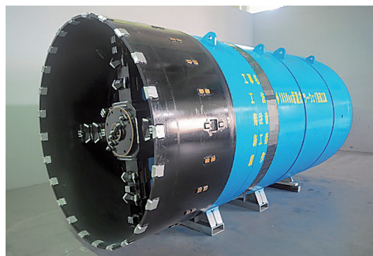
写真-1 SRC掘進機 Type1
