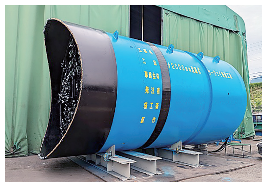
写真-2 SRC掘進機 Type II
