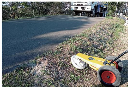
写真-1 電柱立替工事前のGPR探査
