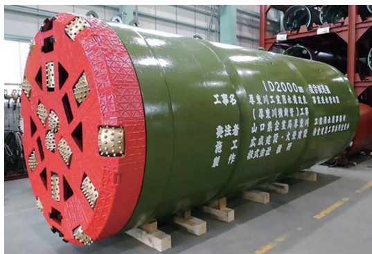
写真-1 CMT複合掘進機（岩盤対応）
