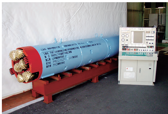
写真-2 サクセスモールの掘進機
