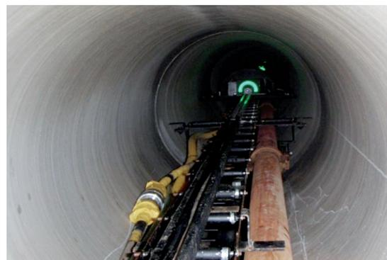
写真-4 管内CCDカメラセンサLED点灯
