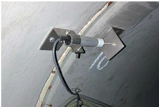
写真-2 変位計設置状況
