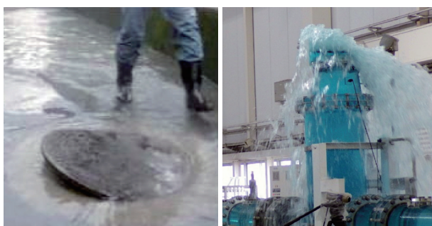
写真-1 豪雨時の蓋の外れ(左)とマンホールからの噴出の様子(右) (水理模型実験)
