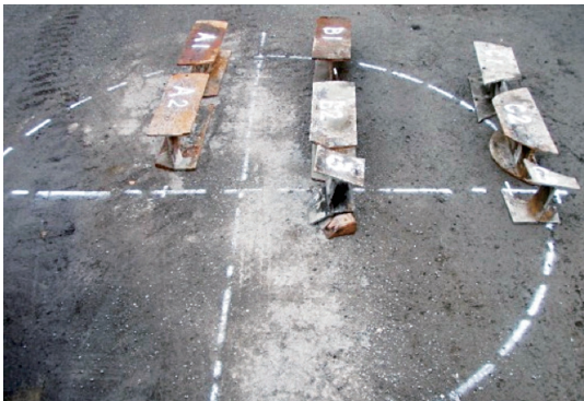
写真-2 シールド断面における切断回収した杭
