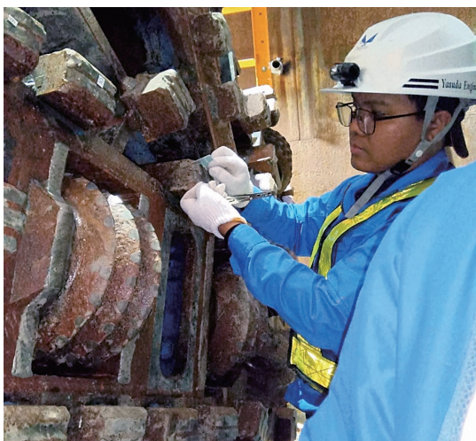
写真-3 現在の部署での仕事 リングモールビット摩耗測定
