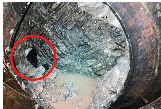
写真-1 面板に鋼材が噛み込んだ状態で回収された先導体
