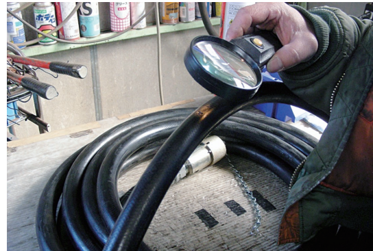
写真-1 油圧ホースの点検
