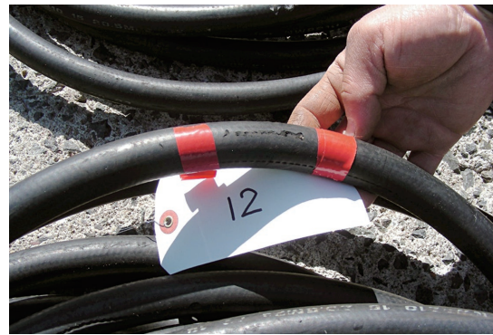
写真-2 油圧ホースの裂傷
