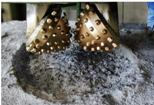
写真-5 掘削効果実験
