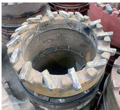
写真-1 切削型掘削ビット
