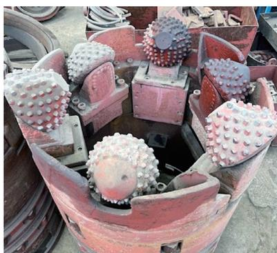
写真-2 圧砕型掘削ビット
