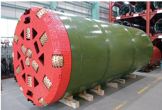
写真-1 岩盤用掘進機
