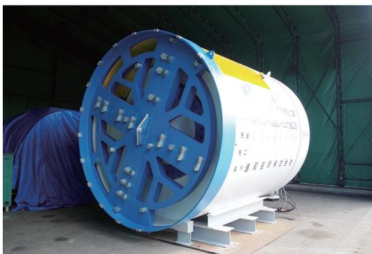
写真-1 崩落防止板を装備した掘進機全景
