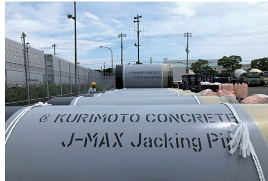
写真-1 撥水性の塗料を塗布した推進管
