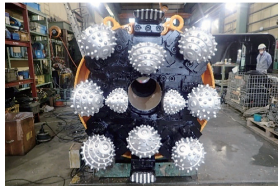
写真-2 掘進機面盤状況
