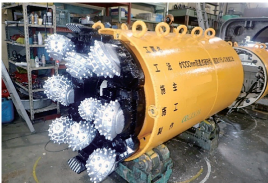
写真-1 掘進機全景(3胴管)
