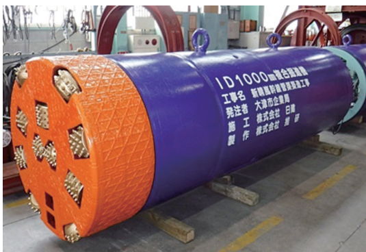
写真-1 長距離推進用CMT工法用掘進機
