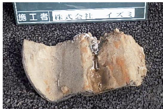
写真-4 撤去した鋼矢板
