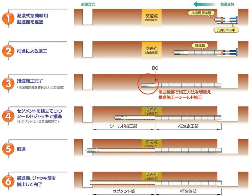
図-2 デュアルシールド工法の施工手順
