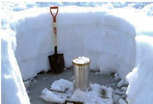
写真-1 雪で埋まった雨量計。雨量計の設置場所にも配慮がいる
