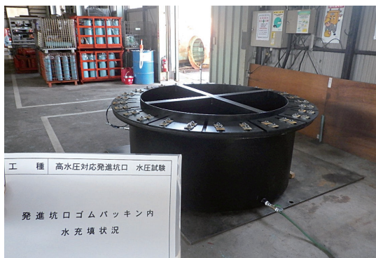
写真-1 高水圧対応L型エントランスパッキンの止水実験風景
