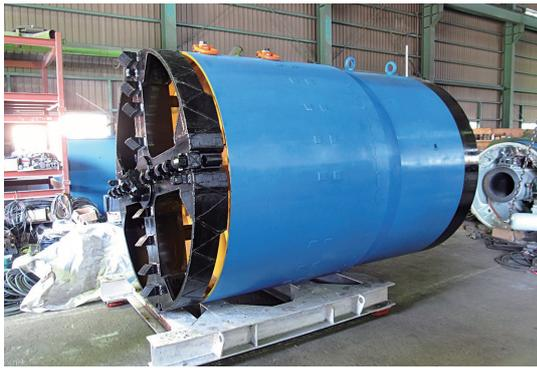
写真-1 呼び径1650外筒残置回収型掘進機
