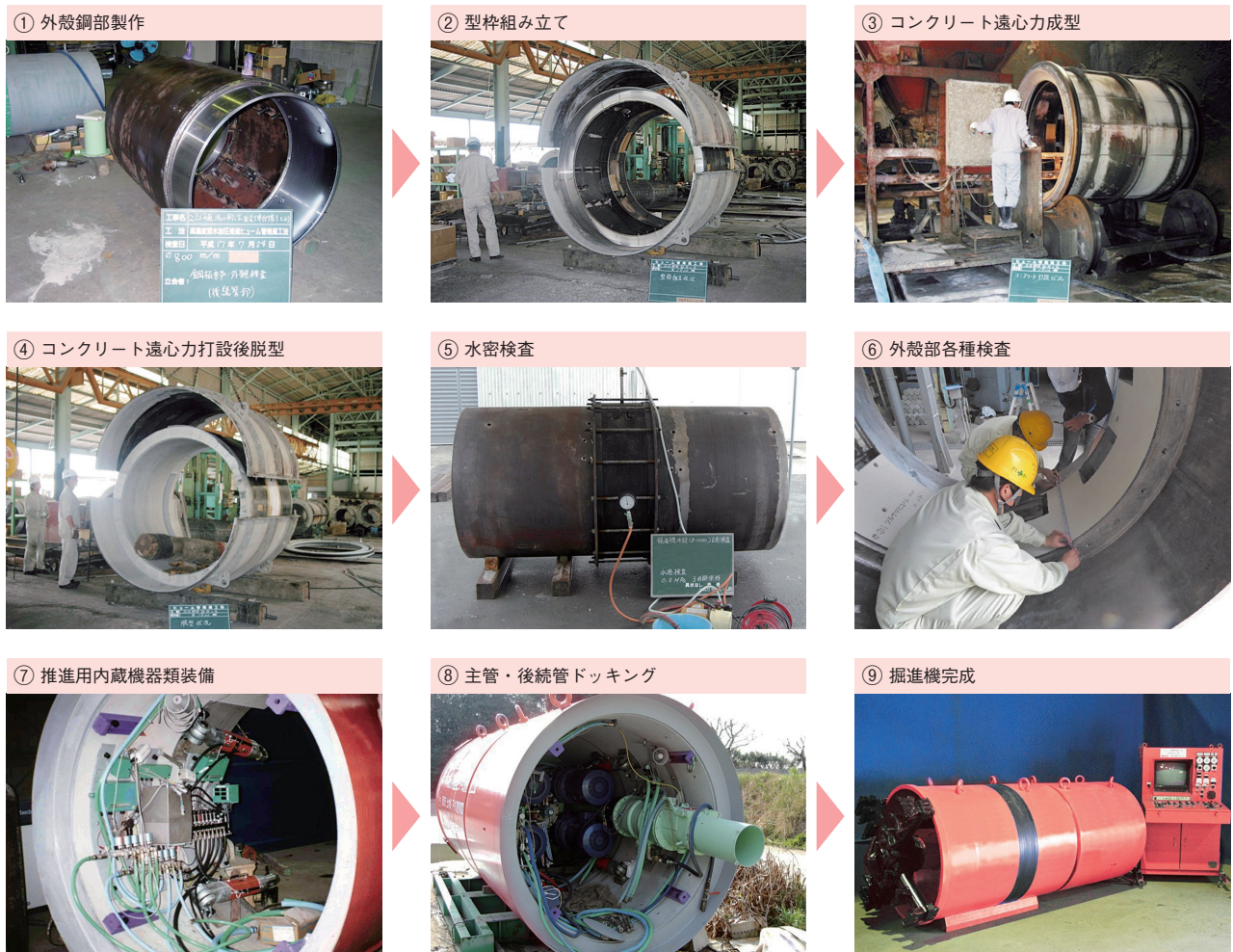
写真-1 掘進機製作工程
