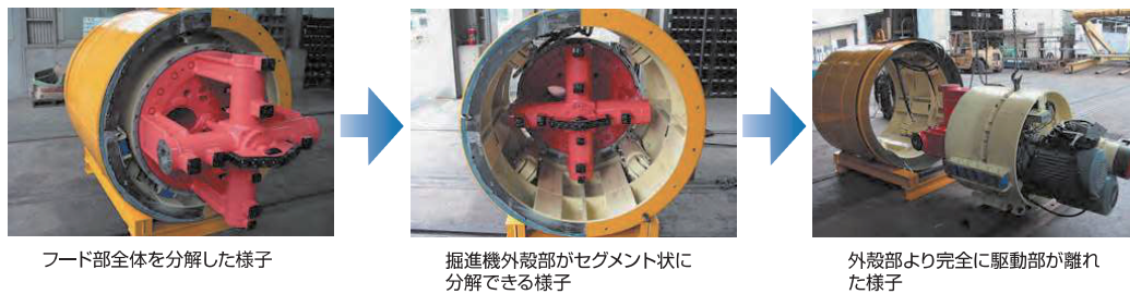
図-2 掘進機分解回収フロー
