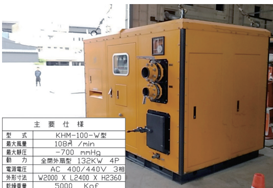
写真-1 吸泥排土装置 132kW
