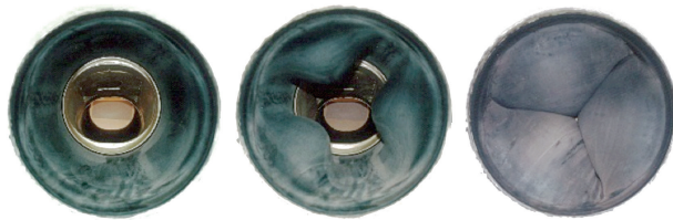
写真-2 排土バルブ開閉状況
