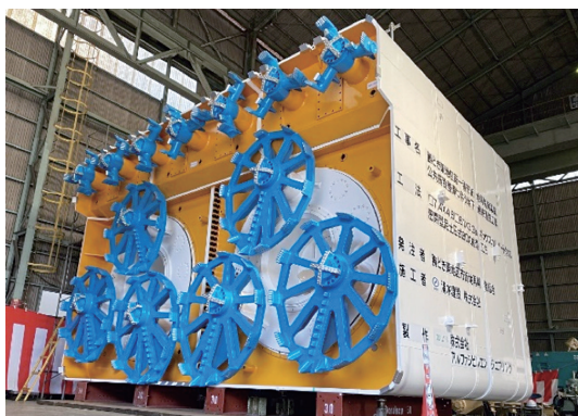
写真-3 □7,400×4,600mmボックス掘進機：連絡通路
