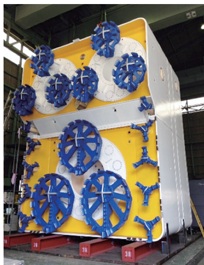
写真-2 □5,000×6,300mmボックス掘進機：車歩道
