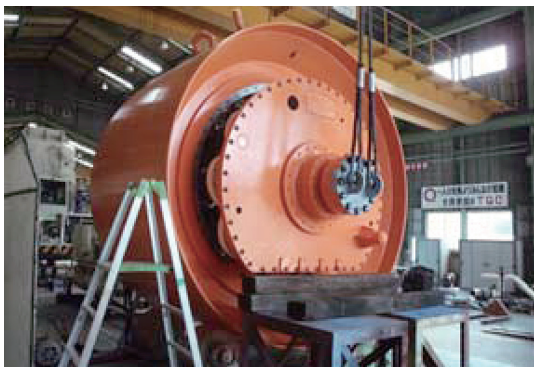
写真-1 工場での掘進機駆動部解体状況①
