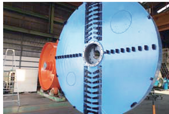
写真-3 解体された掘進機面板
