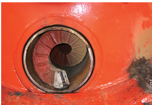
写真-1 バルクヘッド部のスクリュコンベヤ
