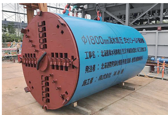
写真-1 RCM型掘進機（普通土対応型）
