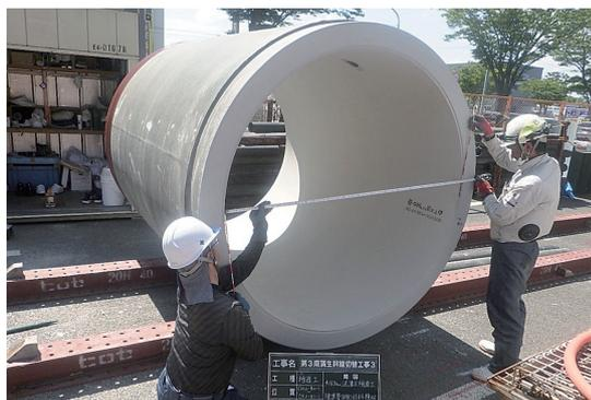
写真-1 SR-JD管（納品検査状況）
