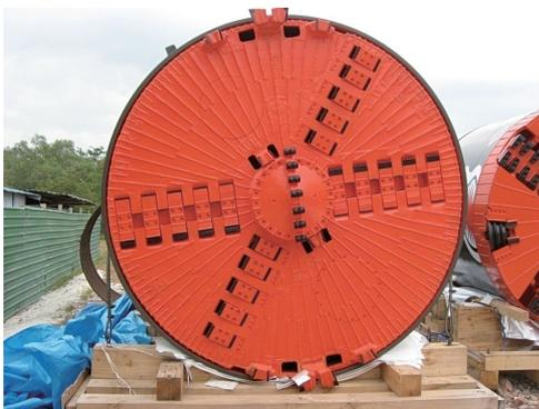
写真-1 面板掘削タイプ掘進機
