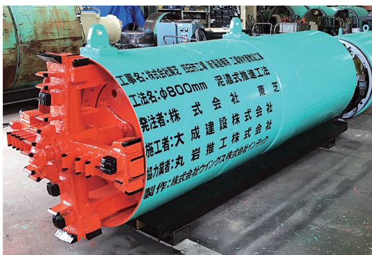
写真-1 呼び径800泥濃式掘進機
