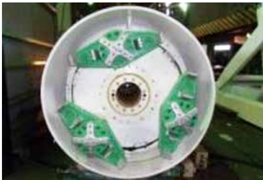
写真-2 カッタ格納（停止時・リターン時）
