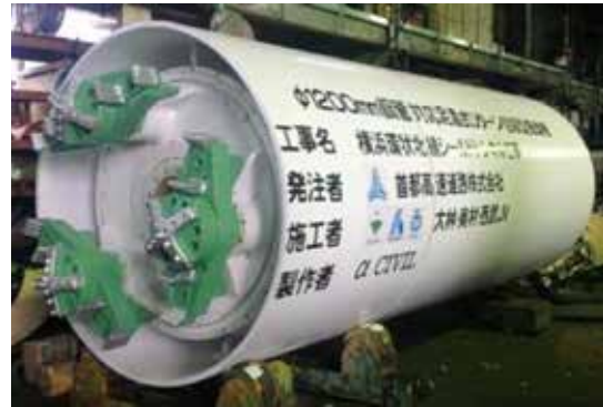
写真-3 密閉型泥濃式パイプルーフ掘進機全景（多軸自転公転型 地中リターン機能付）
