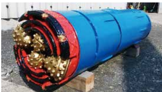
写真-1 礫対応型先導体
