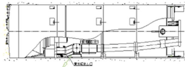
図-4 岩盤掘削時の送水吹き出し口(管外吹き出し機構)
