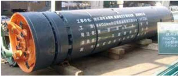
写真-1 ジャット工法呼び径400先導体
