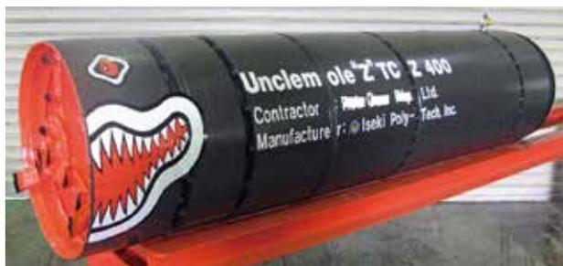
写真-1 アンクルモールZ工法の先導体
