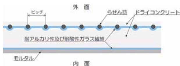
図-1 JSWAS A-8の管体構造
