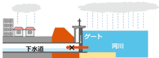
図-2 樋門等による逆流防止のイメージ
