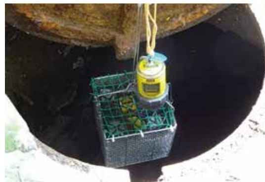
写真-2 テストピースと硫化水素計
