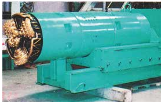
写真-2 縦掘削用ビットを転用した例
