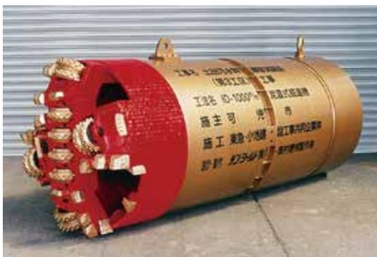
写真-2 初めて施工に用いられたラムサスLXヘッド(岐阜県可児市)
