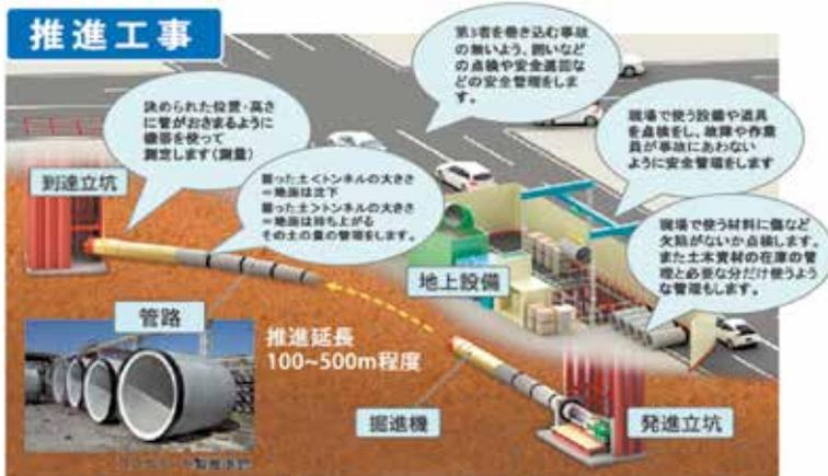
図-2 ラムサス工法のスタッフのポジションと施工管理項目 (サンシールド株式会社内教育資料より)
