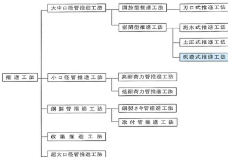
図-1 推進工法の分類<sup>1)</sup>
