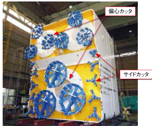
写真-1 掘進機組立全景 2)
