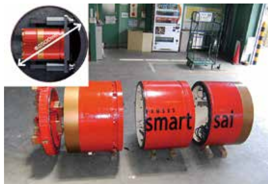
写真-1 小型立坑発進型掘進機
