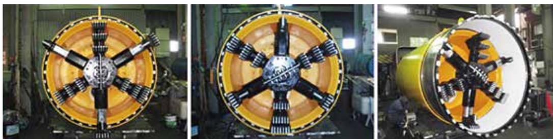
写真-1 貫入リング（回転切削型）接続工法で用いられる掘進機
